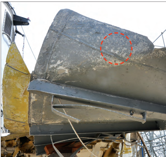
◀ 천안함 침몰해역에서 수거한 북한산 어뢰 잔해인 추진부 프로펠러에 비결정성 알루미늄 산화물이 하얗게 정착돼 있다. ▶ 동일한 성분의 비결정성 알루미늄 산화물이 연돌 등 천안함 곳곳에서도 발견돼 천안함 사태의 원인이 북한임을 입증했다.
