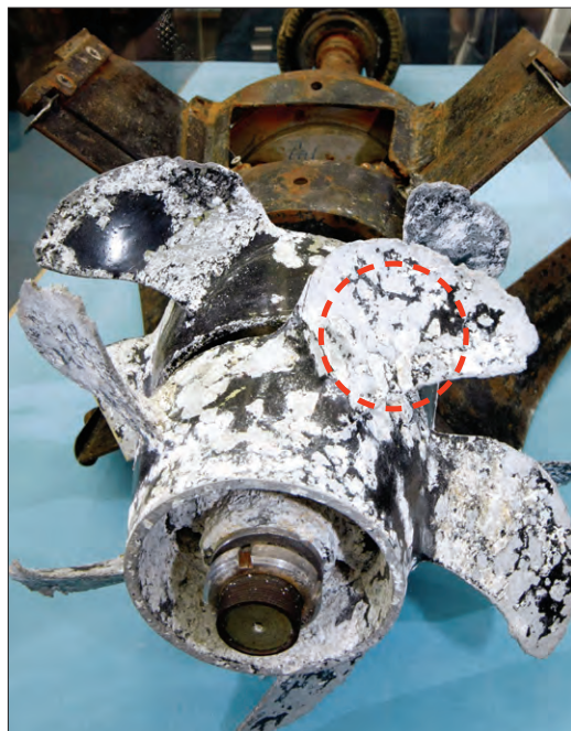
◀ 천안함 침몰해역에서 수거한 북한산 어뢰 잔해인 추진부 프로펠러에 비결정성 알루미늄 산화물이 하얗게 정착돼 있다. ▶ 동일한 성분의 비결정성 알루미늄 산화물이 연돌 등 천안함 곳곳에서도 발견돼 천안함 사태의 원인이 북한임을 입증했다.
