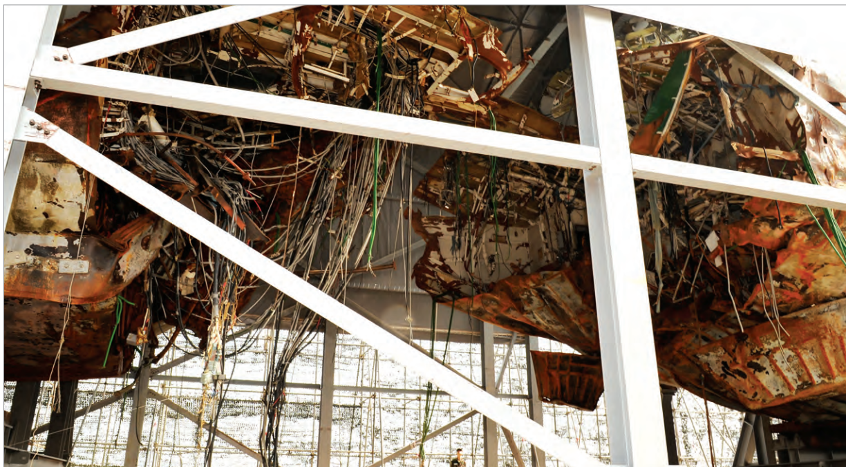
천안함 함수(사진 오른쪽)와 함미 사이의 절단면. 화재 흔적이 없는 전선과 위로 올라붙은 선저 등은 천안함이 수중폭발로 인한 버블제트 현상으로 침몰했음을 보여주고 있다.
